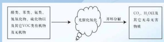
智能一体化废气净化系统技术原理图
