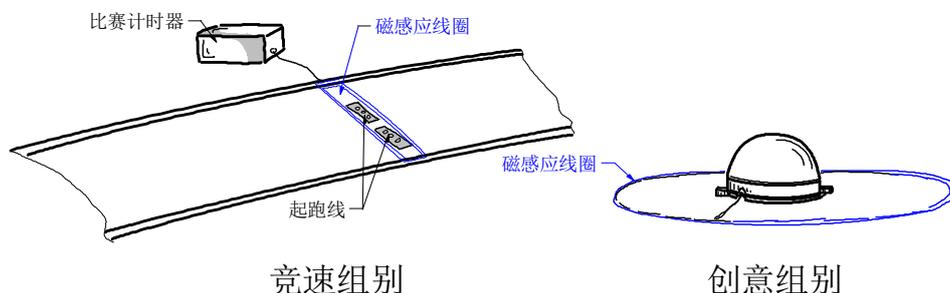
图 11 基于磁感应的比赛计时系统
