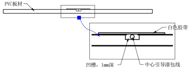
图 5 电磁引导线固定方式
