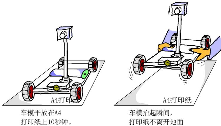
图 17 车轮胎 A4 纸粘性检查
