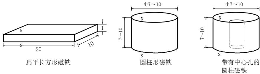
图 20 用于磁标的钕铁硼永磁铁
